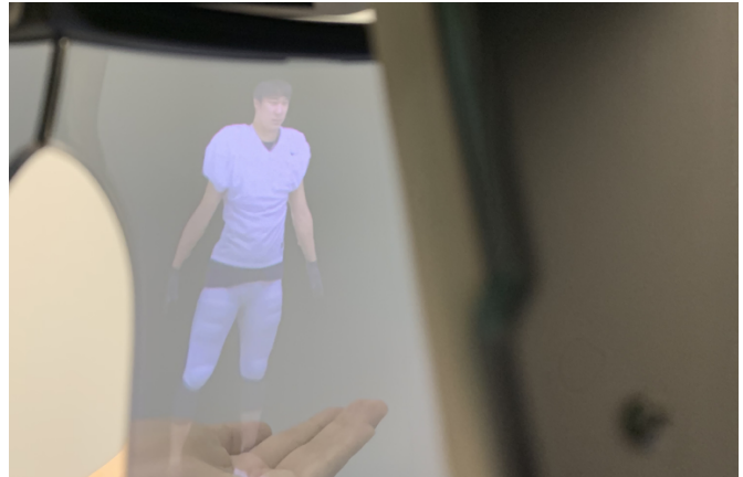
Leap Motion により手を認識し、グラス越しに選手の 3D アバターの手のひらに乗せることも可能
